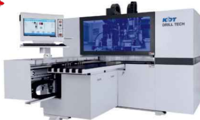
Сверильно-присадочный центр с ЧПУ KDT KD-812A + робот ABB
